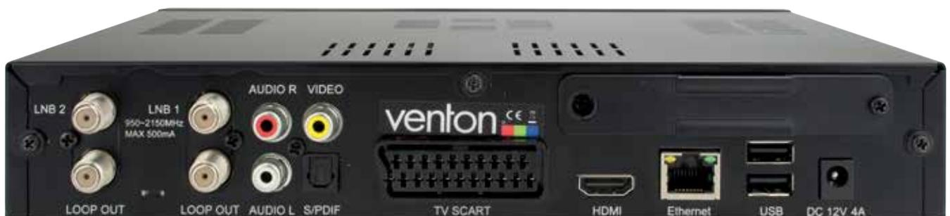
**Rückseite** An der rechten Seite ist der Wechselrahmen für den Einbau einer internen 2,5"-Festplatte zu erkennen. Links ist der Twin-Tuner samt Durchschleiffunktion zu sehen, der ausgetauscht werden kann. Ein Netzschalter fehlt leider. Der Anschluss für ein 12V-Netzteil macht die Unibox auch für den mobilen Gebrauch interessant.
