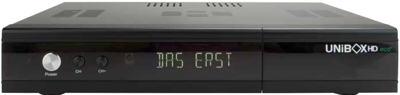
**Front** Das alphanumerische Display besitzt leider nur acht Stellen, wodurch es viele Sendernamen nicht vollständig anzeigen kann. Immerhin ist es dimmbar und auch aus größerer Entfernung gut lesbar. Hinter der Frontklappe an der rechten Seite befinden sich ein Kartenleser und ein CI-Schacht. Der Standby-Schalter und zwei Kanalwahltasten sind die einzigen Nahbedienelemente an der Front.
