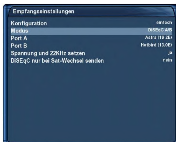
Zwei Satelliten über DiSEqC A/B
