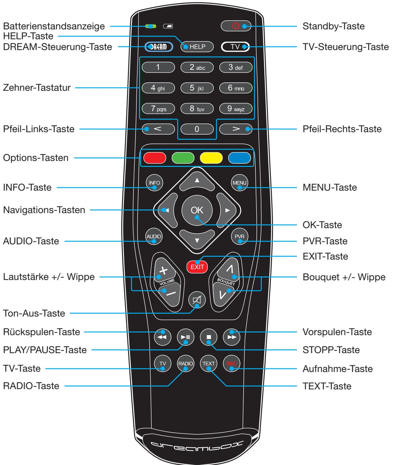
**Batteriestandsanzeige** zeigt den Status des Batteriestands an.
