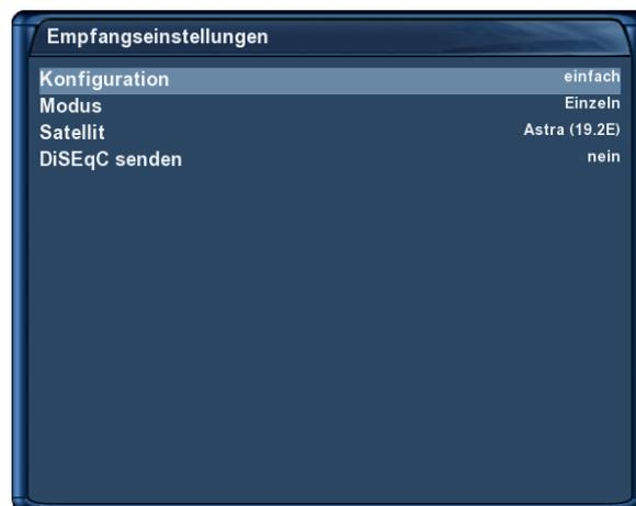
Einzelner Satellit - direkte Verbindung
