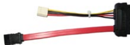
SATA Kabel inklusive Stromkabel für eine 2,5" SATA-Festplatte
