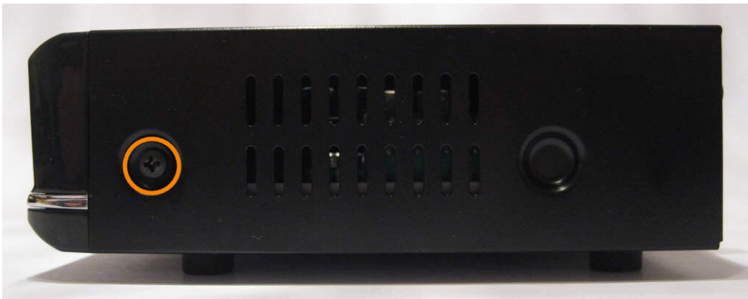
Schraube auf der rechten Seite entfernen
