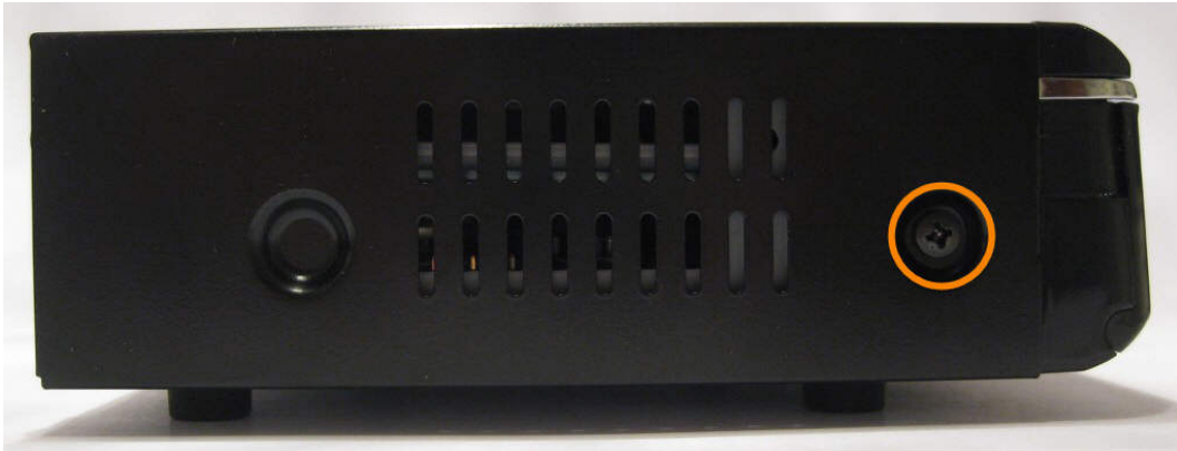
Schraube auf der linken Seite entfernen
