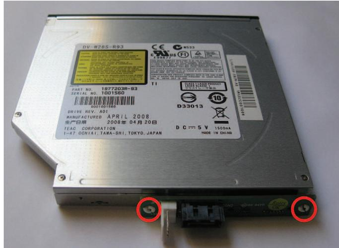
4. Befestigen Sie das DVD-Laufwerk mittels der vier kleinen Schrauben am Rahmen.
