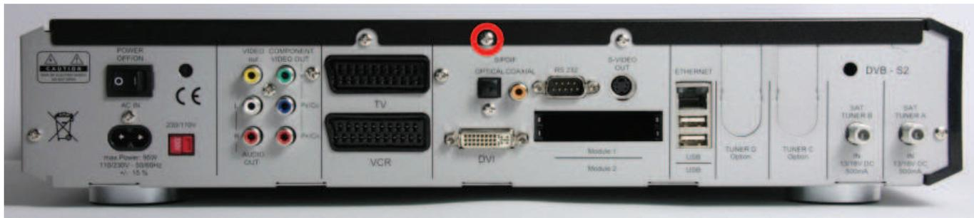
Rückseite, mittlere Schraube lösen
