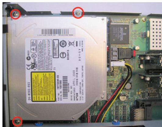
6. Stecken Sie nun das rote SATA-Kabel und den weißen Stromstecker in den SATA-Adapter am DVD-Laufwerk.
