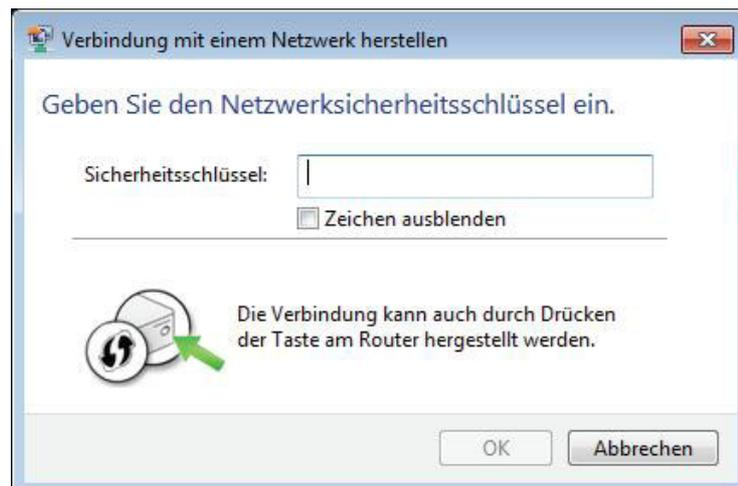
5. Falls Ihr Router nicht über eine WPS-Funktion verfügt oder per WPS keine automatische Verbindung zum Dongle hergestellt werden kann, können Sie die Verbindung auch einrichten, indem Sie den Sicherheitsschlüssel (auch als Netzwerkschlüssel oder WLAN-Passwort bezeichnet) manuell in das Feld eingeben. Achten Sie auf die exakte Schreibweise. Den Schlüssel (sofern benötigt) erhalten Sie vom Administrator Ihres Netzwerkes. Die Verbindung wird hergestellt.
